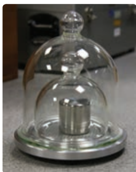
شکل ۱-۷ استاندارد ملی کیلوگرم که نسخه دقیق‌تری از استاندارد بین‌المللی سیور فرانسه است. این نمونه، در مرکز اندازه‌شناسی در سازمان ملی استاندارد ایران نگاه‌داری می‌شود.
