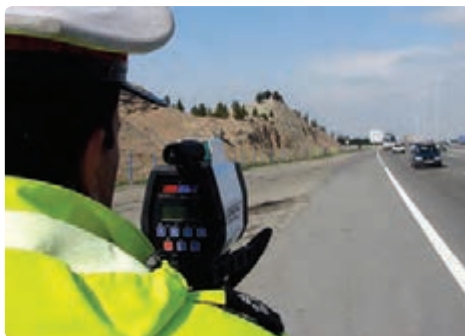
شکل ۳۰-۳۰ تعیین تندی خودروها به کمک اثر دوپلر
