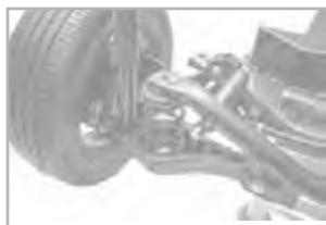
شکل ۲-۱۴ فنرهای به کار رفته در چرخ‌های خودرو
