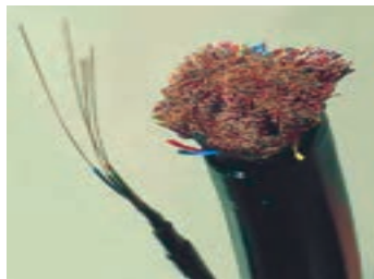
ب) یک کابل سبک تار نوری (شکل سمت چپ) می‌تواند مکالمه‌های تلفنی بسیار بیشتری را از یک کابل سیمی معمولی (شکل سمت راست) انتقال دهد.
