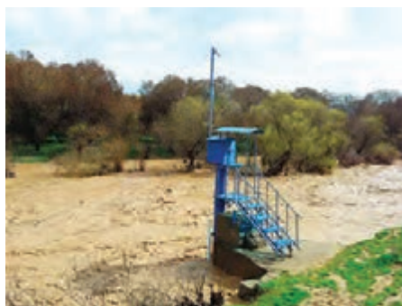
شکل ۲-۳. ایستگاه اندازه‌گیری آبدهی رود
