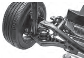
شکل ۲-۱۴ فنرهای به کار رفته در چرخ‌های خودرو
