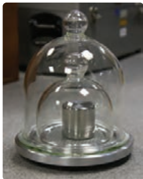
شکل ۱-۷ استاندارد ملی کیلوگرم که نسخه دقیقی از استاندارد بین‌المللی سیور فرانسه است. این نمونه، در مرکز اندازه‌شناسی در سازمان ملی استاندارد ایران نگهداری می‌شود.
